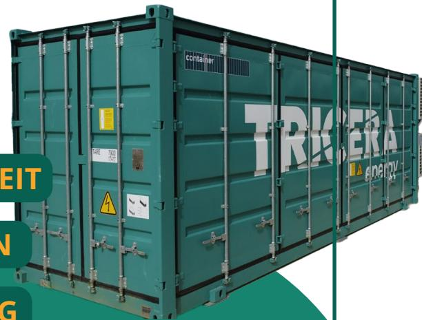
Der **TRICERA 24ft HC-Container** ist ein Batteriespeicher mit einem kompakten 1500-V-Design, welches Batterien, Kommunikation und Steuerung, Klimasystem und umfangreiche Sicherheitsfunktionen effizient und platzsparend zusammenbringt, und für alle klimatischen Bedingungen geeignet ist.
